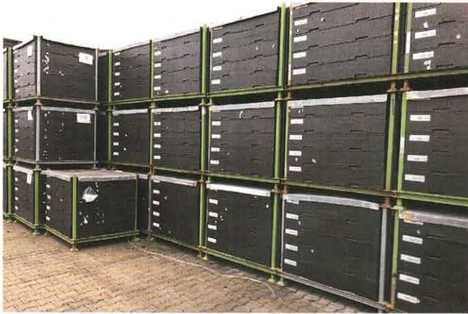
Bild 2. Die ausgemusterten Ladungsträger werden gesammelt, verdichtet und anschließend zu Granulat verarbeitet (© JSP)
