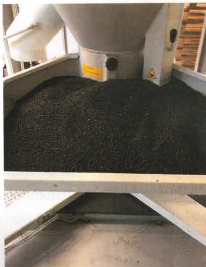
Bild 3. Im hessischen Eschwege werden die gesammelten Ladeträger zu EPP-Regranulat verarbeitet und anschließend im Labor auf Schlüsselkriterien untersucht (© GID)
