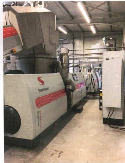
Bild 3. Im hessischen Eschwege werden die gesammelten Ladeträger zu EPP-Regranulat verarbeitet und anschließend im Labor auf Schlüsselkriterien untersucht (© GID)
